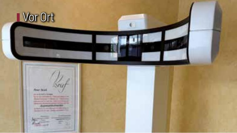
Mit dem Visufit 1000 können Brillengläser für Gleitsichtbrillen auf ein Zehntelmillimeter genau zentriert werden.
