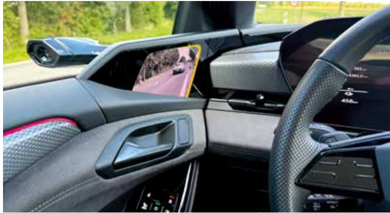
Die digitalen Außenspiegel ersetzen die konventionellen Spiegel. Die Kamerabilder erscheinen auf Displays in den Fahrzeugsüren.
